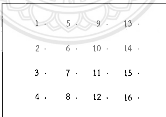
รูปที่ 3.31 ลำดับในการออกแบบการเจาะรูที่ 1-16 บนแผ่นสแตนเลส
