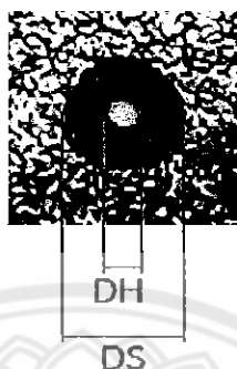
รูปที่ 4.2 การวัดเส้นผ่านศูนย์กลางของรูเจาะบนผิวชิ้นงาน (DS) และขนาดรูเจาะ (DH)
