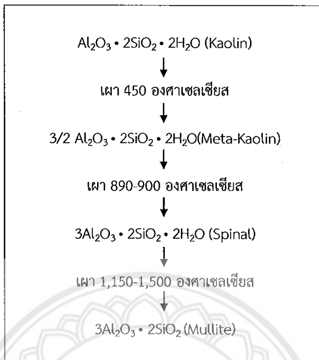
รูปที่ 2.10 ปฏิกริยาของดินขาว เมื่อผ่านอุณหภูมิต่างๆ และการเปลี่ยนแปลงรูปผลึกทางโครงสร้างเคมี
