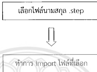
รูปที่ 3.10 ขั้นตอนในการนำไฟล์เขียนแบบเข้าสู่โปรแกรม COMSOL
