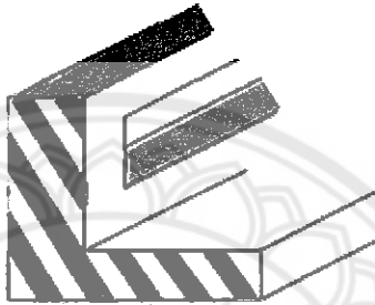
รูปที่ 2.28 เครื่องหมายแถบเฉียงสลับสี ที่มา : กรมทางหลวง กระทรวงคมนาคม
