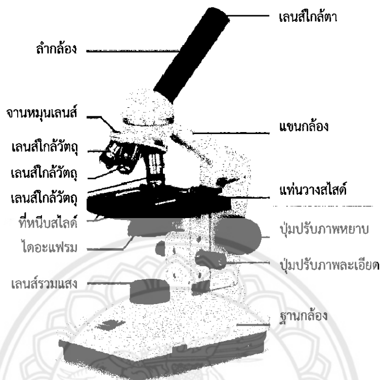
รูปที่ 2.9 ส่วนประกอบของกล้องจุลทรรศน์แสง
