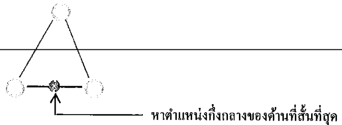
รูปที่ 3.22 การจำลองการหาคำแหน่งกึ่งกลางของด้านที่สั้นที่สุด ของตัวต้นแบบ ชนิดที่มี 3 จุด
