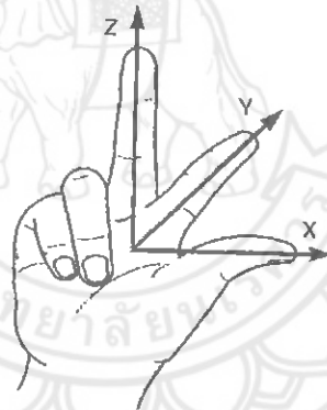
รูปที่ 2.11 กฎมือขวาใช้ในการกำหนดทิศทางเคลื่อนที่ของเครื่องจักรซีเอ็นซี ที่มา: สมบัติ (2551)
