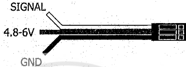
รูปที่ 2.3 ลักษณะสายสัญญาณของเซอร์โวมอเตอร์ [1]
