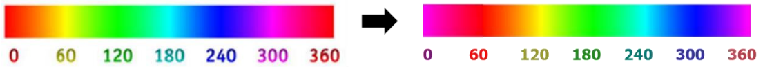
ภาพ 18 ผลลัพธ์การแปลงองศาของสีในแบบจำลองสี HSV โดย Mu และคณะ
