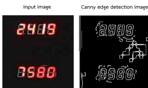
ภาพ 2 ตัวอย่างผลลัพธ์การตรวจจับเส้นขอบด้วย Canny edge detection
