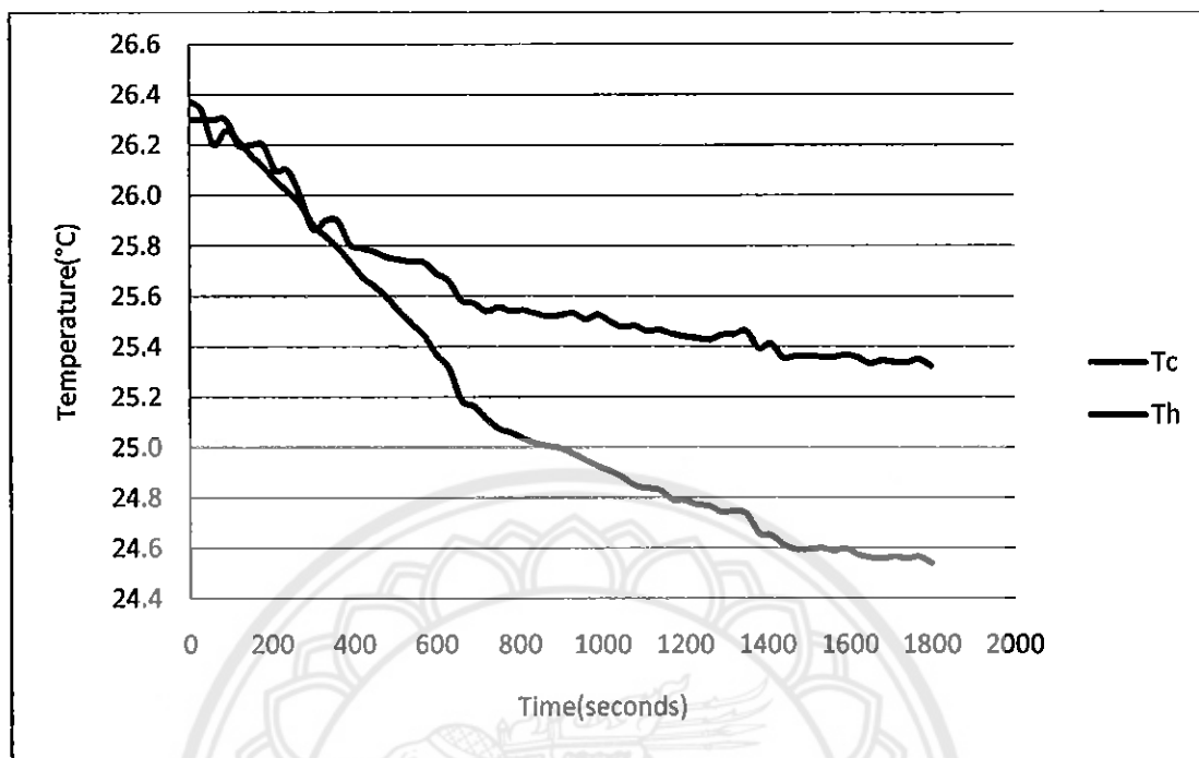
รูปที่ 4.22 กราฟแสดงอุณหภูมิแตกต่าง ที่ระยะ x_h = 1.0 ซม. \Delta T_{max} = 0.8^\circ\text{C}
