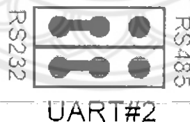
รูปที่ 2.5 แสดงการ Set Jumper UART#2 เมื่อใช้งานขั้วต่อ RS232#2
