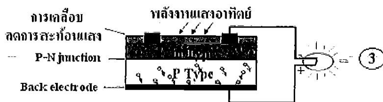
รูปที่ 2.22 การทำงานของเซลล์แสงอาทิตย์
