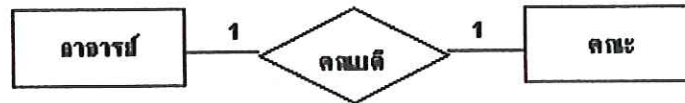
รูปที่ 2.6 แสดงความสัมพันธ์แบบหนึ่งต่อหนึ่ง (One-to-one Relationship) [5]
