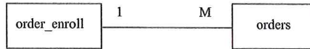
รูปที่ 4.14 ความสัมพันธ์ระหว่างตาราง order_enroll และตาราง orders
