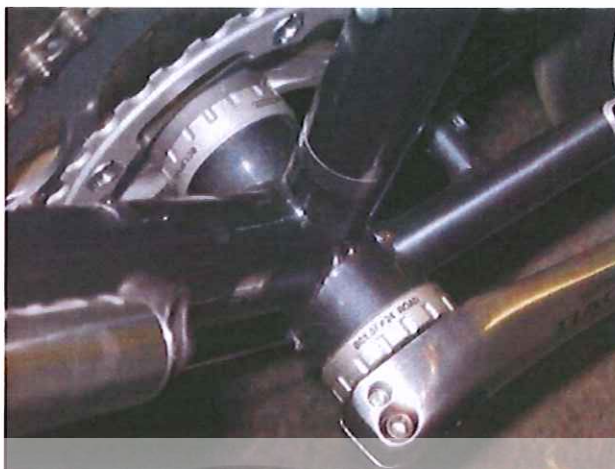
ภาพ2.35แสดง Bottom Bracket เมื่อใส่อยู่กับเฟรม
