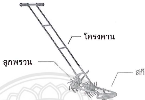
รูปที่ 2.3 ส่วนประกอบหลักของเครื่องพรวนกำจัดวัชพืชชนิดใช้แรงคนเข็น [5]
