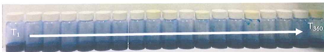
รูปที่ 4.6 ตัวอย่างสารละลายสีย้อมที่เวลาต่างๆ ที่อัตราการไหล 10 มิลลิลิตรต่อนาที ขนาดของตัวดูดซับ 12 เมช ความสูง 5 เซนติเมตร ความเข้มข้นเริ่มต้นของสารละลายสีย้อมเมทิลีนบลู 600 มิลลิกรัมต่อลิตร
