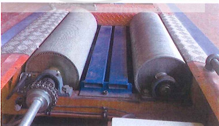
รูปที่ 2.4 ลักษณะลูกกลิ้งของ Dynamometer
