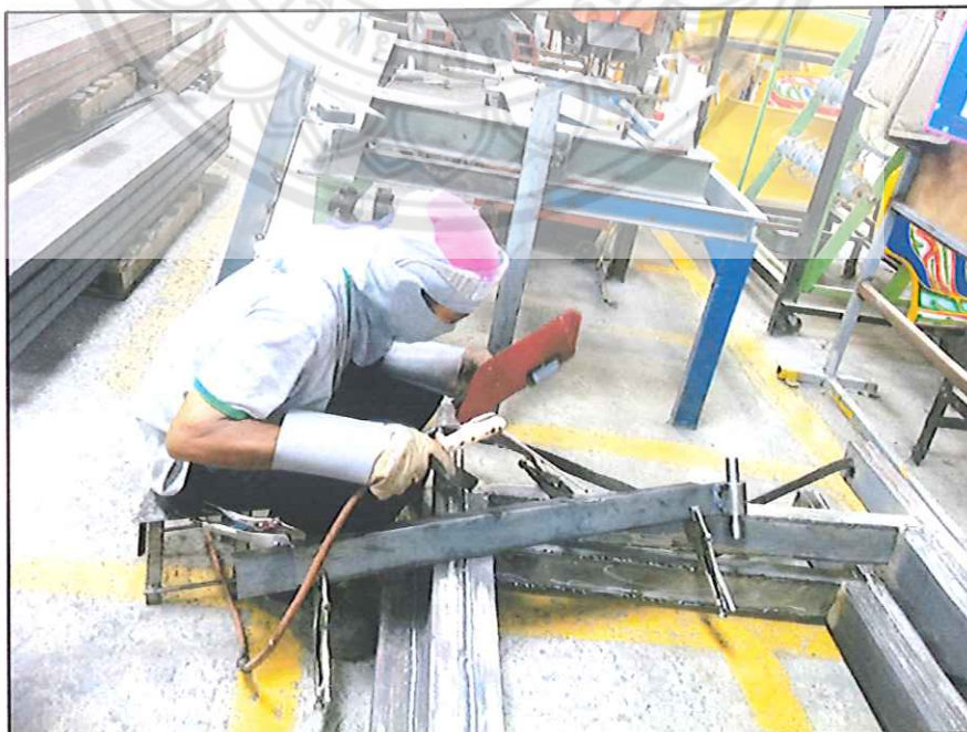
รูปที่ 4.31 ทำการเชื่อมเป็นระยะๆ
