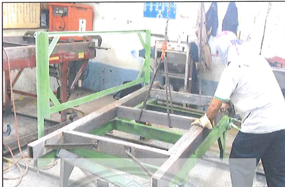
รูปที่ 4.44 ยกฐานชิ้นงานวางบนฐานฟิกซ์เจอร์
