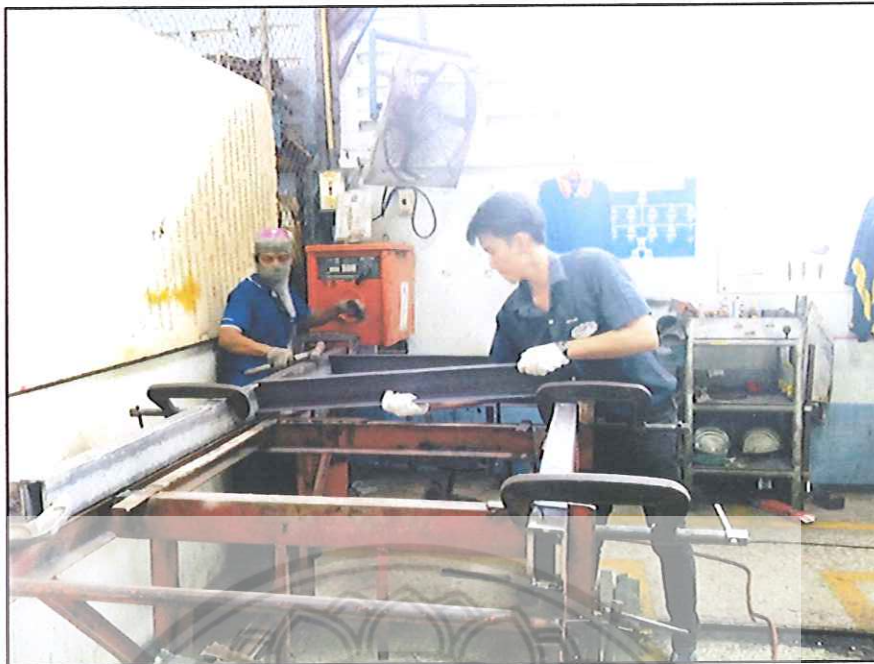
รูปที่ 4.27 ทำการสร้างฐานฟิกส์เจอร์โครงรถเกี่ยวขนาดข้าว
