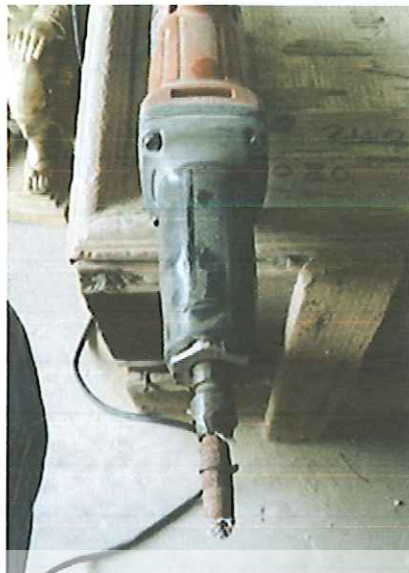
รูปที่ 4.24 แสดงหัวขั้วที่พันกับกระดาศทรายแล้วแต่ไม่มีตำแหน่งบอกก่อน
