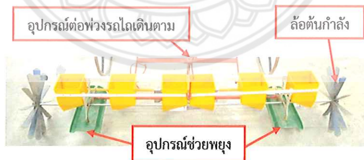
(ข) เครื่องโรยเมล็ดข้าวอกแบบต่อพ่วงรถไถเดินตาม
