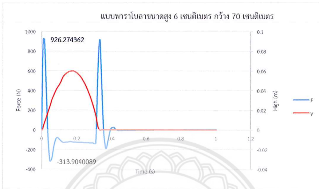
รูปที่ 4.21 กราฟแสดงขนาดแรงของพาราโบลาขนาดสูง 6 เซนติเมตร กว้าง 70 เซนติเมตร
