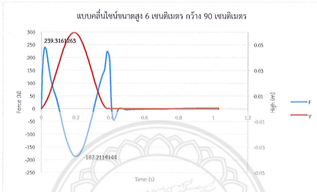
รูปที่ 4.37 กราฟแสดงขนาดแรงของแบบคลื่นไซน์ขนาดสูง 6 เซนติเมตร กว้าง 90 เซนติเมตร
