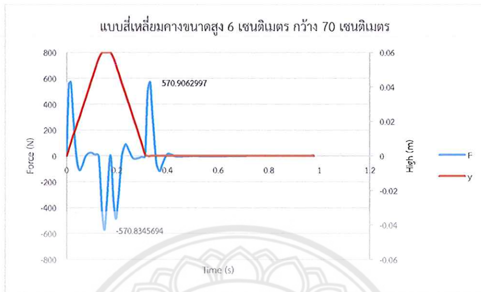
รูปที่ 4.33 กราฟแสดงขนาดแรงของแบบสี่เหลี่ยมคางขนาดสูง 6 เซนติเมตร กว้าง 70 เซนติเมตร
