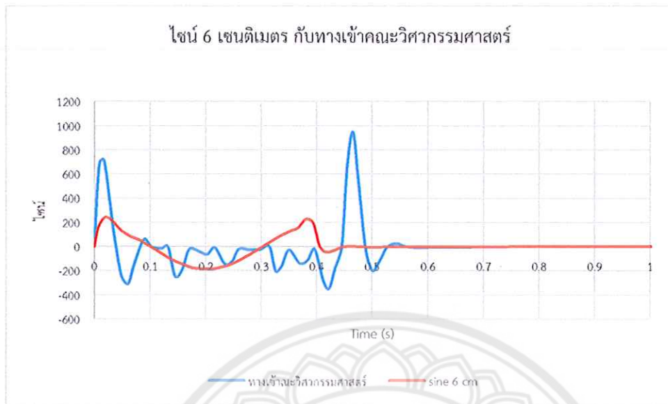
รูปที่ 5.1 เปรียบเทียบแรงสั่นสะเทือนความเร็วแบบไซน์ 6 เซนติเมตร กับ สั่นสะเทือนความเร็วทางเข้าคณะวิศวกรรมศาสตร์
