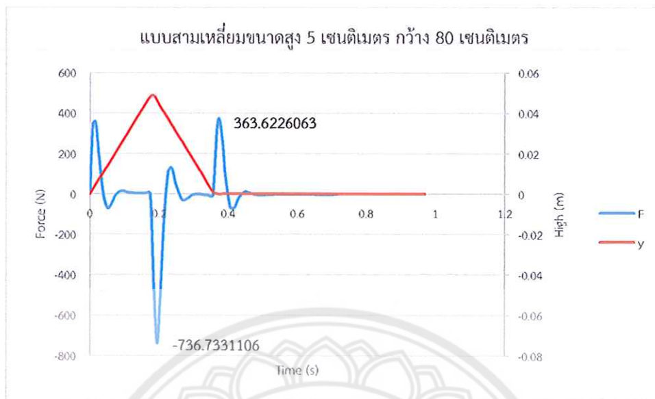
รูปที่ 4.29 กราฟแสดงขนาดแรงของแบบสามเหลี่ยมขนาดสูง 5 เซนติเมตร กว้าง 80 เซนติเมตร
