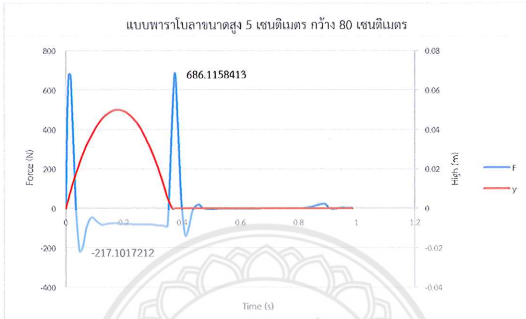
รูปที่ 4.23 กราฟแสดงขนาดแรงของพาราโบลาขนาดสูง 5 เซนติเมตร กว้าง 80 เซนติเมตร
