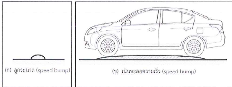
รูปที่ 2.9 ประเภทของสันชะลอความเร็วที่พบได้โดยทั่วไป (ก) ลูกกระพรวน (ข) เนินชะลอความเร็ว
