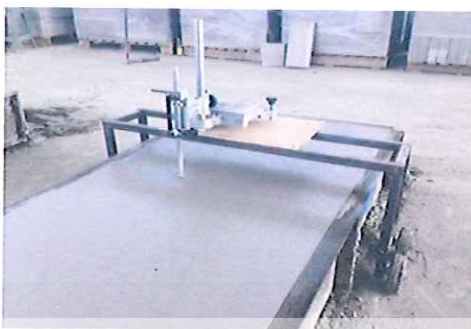
รูปที่ 3.10 การวางเครื่องทดสอบแบบไวแคตบนฟิซเจอร์
