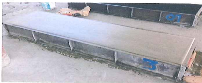
รูปที่ 3.9 แบบหล่อหลังจากเทส่วนผสมและปาดผิวหน้า
