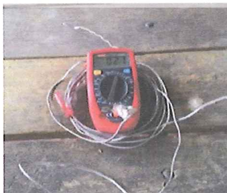
รูปที่ 3.9 ชุดวัดอุณหภูมิ (Digital Thermometer) และสายวัดอุณหภูมิ ประเภทเค (Type K)
