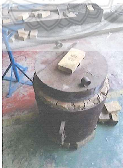
รูปที่ 3.2 เตาหลอมโลหะโดยใช้แก๊ส
