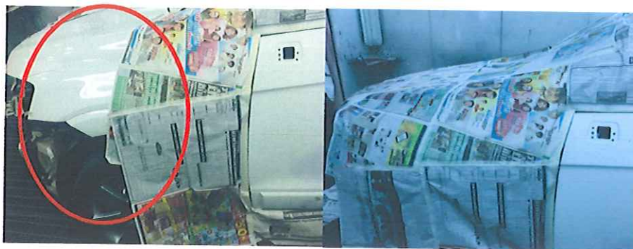
รูปที่ 4.33 แสดงการติดกระดาษจากเดิม 1.5 เมตร เปลี่ยนเป็นติด 2 เมตร
