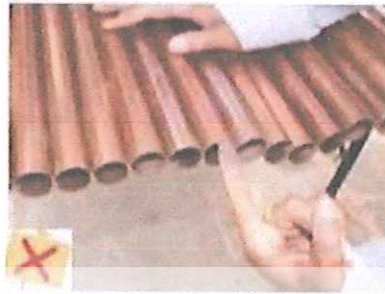
รูปที่ 2.14 การจัดเก็บท่อทองแดงไม่ถูกต้อง มีฝุ่น ไม่ปิดปลายท่อ และวางกับพื้นคอนกรีตโดยตรง [10]
