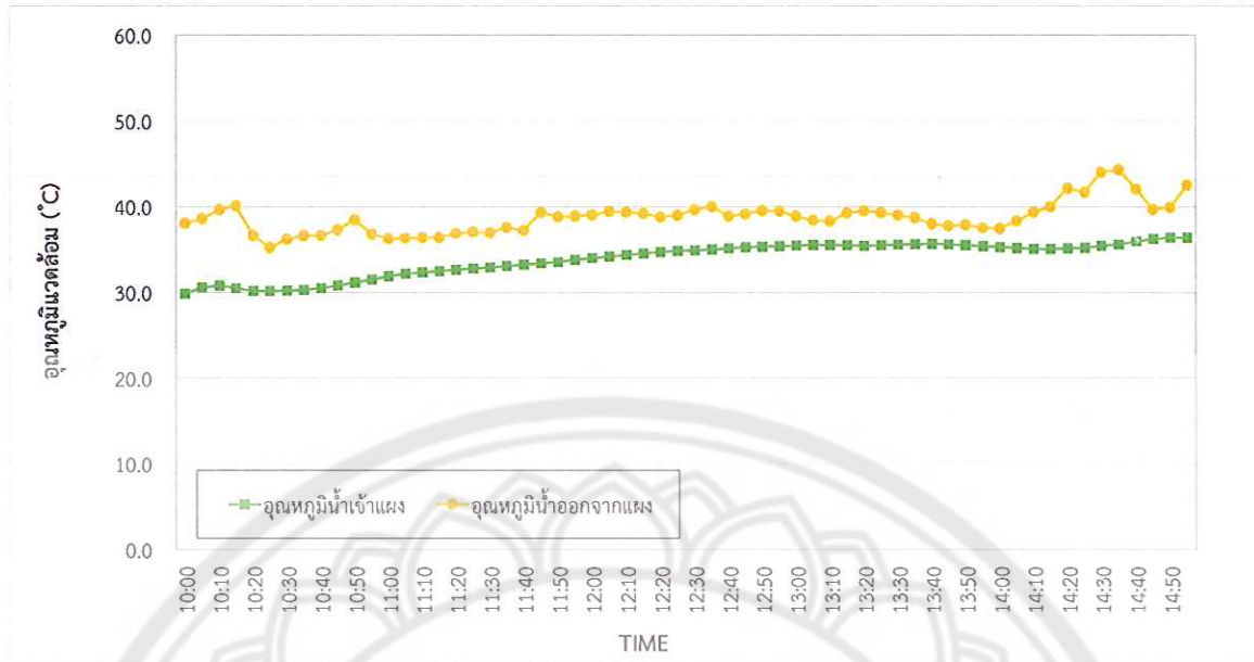
รูปที่ 29 อุณหภูมิน้ำเข้าและน้ำออกจากแผงเซลล์แสงอาทิตย์ วันที่ 22 ธันวาคม 2557
