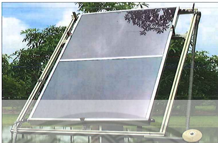
รูปที่ 17 ชุดแผงเซลล์แสงอาทิตย์ชนิดอะมอร์ฟัส (Amorphous silicon) กำลังผลิตรวม 80 วัตต์
