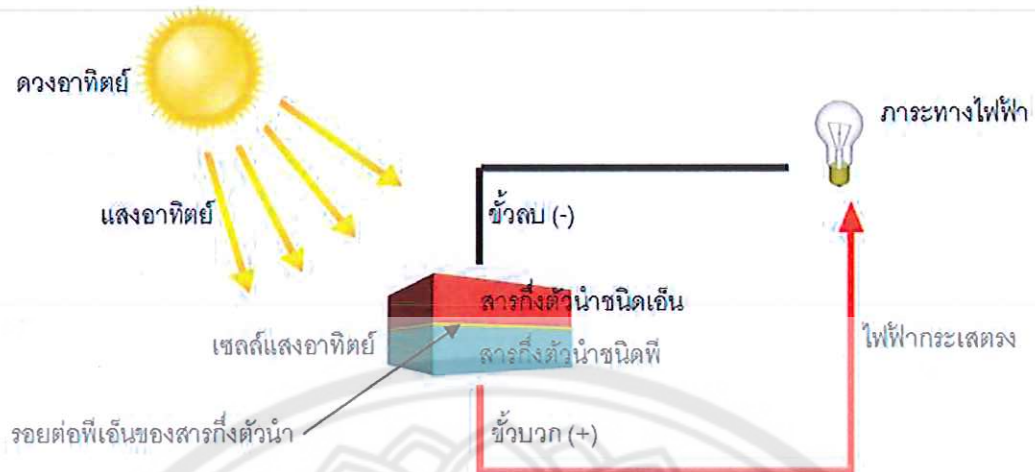
รูปที่ 6 ลักษณะทั่วไปและการทำงานของเซลล์แสงอาทิตย์
