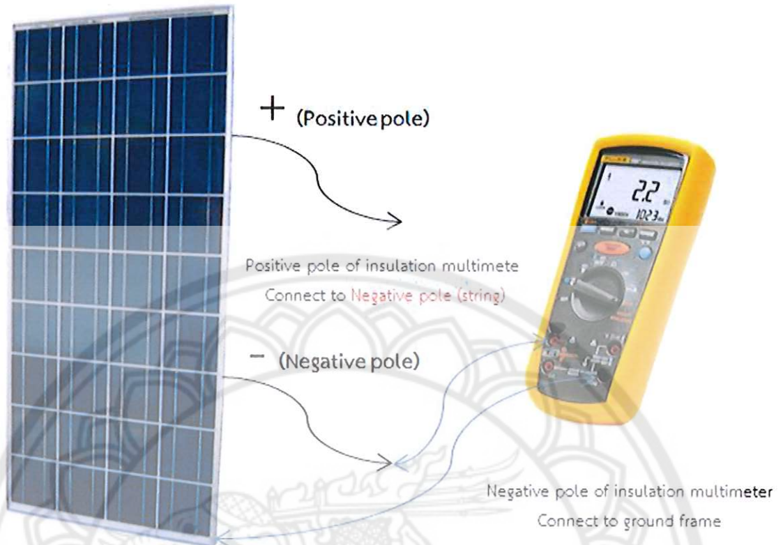
รูปที่ 3.9 แสดงการวัด insulation resistant ที่ขั้วลบ (Negative pole) ของแผงเซลล์แสงอาทิตย์
