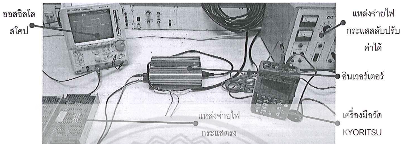
รูปที่ 4.2 ชุดทดสอบจำลองการเชื่อมต่อระบบโฟโตโวลตาอิกกับระบบไฟฟ้าแรงต่ำ 1 เฟส
