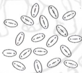
รูปที่ 10 ลักษณะของขั้วคู่ที่วางทิศทางอย่างไม่เป็นระเบียบ [23]
