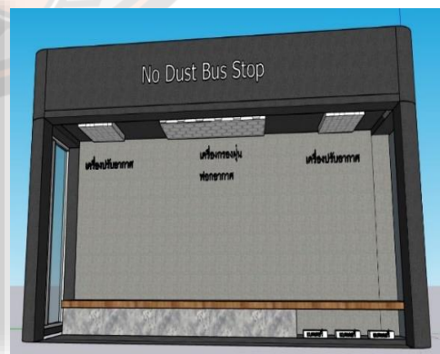
ภาพ 30 การติดตั้งระบบปรับอากาศ ระบบกรองฝุ่น และระบบพอกอากาศ
