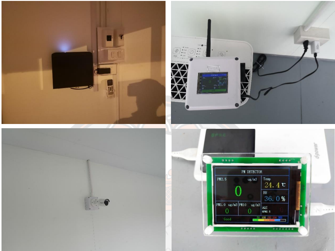
ภาคผนวก จ.-3 การวัดปริมาณฝุ่นละอองขนาดเล็กภายในป้ายรถประจำทางแบบปิดปรับอากาศ
