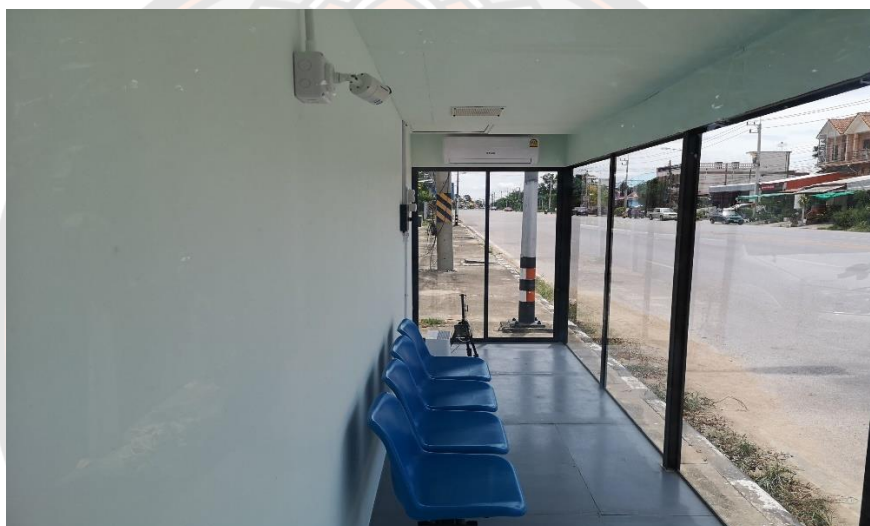
ภาพ 39 ป้ายรถประจำทางแบบปิดปรับอากาศและติดอุปกรณ์กรองฝุ่น
