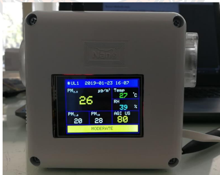
ภาพ 26 เครื่องมือตรวจวัดฝุ่นชนิดพกพา รุ่น PMS7003 (31)
