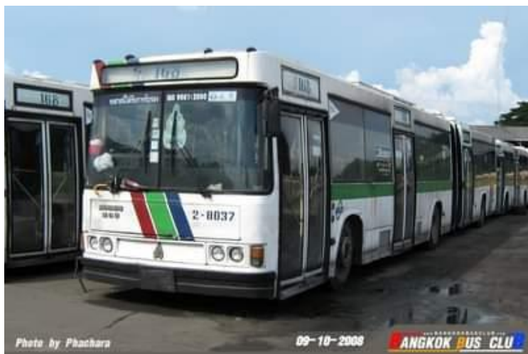
ภาพ 15 รถโดยสารแบบต่อพ่วง (Articulated or bending buses) (37)
