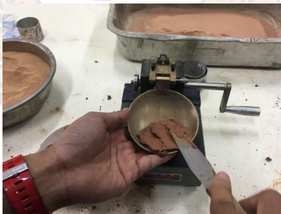
รูปที่ 3-11 การทดสอบค่า Liquid Limits
