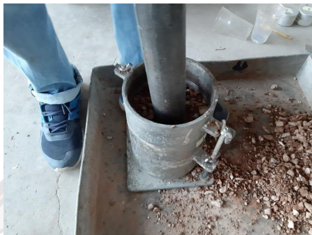
รูปที่ 3-14 การบดอัดแบบสูงกว่ามาตรฐาน
