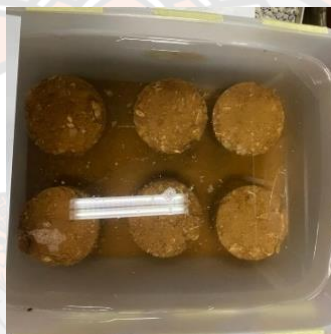
รูปที่ 3-23 นำตัวอย่างที่ทำการบ่มครบเวลา 7 วัน นำมาแช่น้ำเป็นระยะเวลา 5 ชั่วโมง
