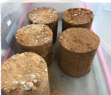
รูปที่ 3-20 ก้อนตัวอย่างหลังจากการบ่มเป็นเวลา 7 วัน
