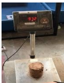
รูปที่ 3-22 การวัดค่าและการชั่งน้ำหนักหลังจากแช่น้ำ 72 ชั่วโมง
