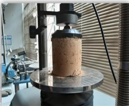
รูปที่ 3-15 การทดสอบแรงอัดแกนเดียว
