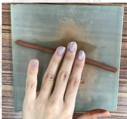
รูปที่ 3-12 การทดสอบ Plastic Limit
