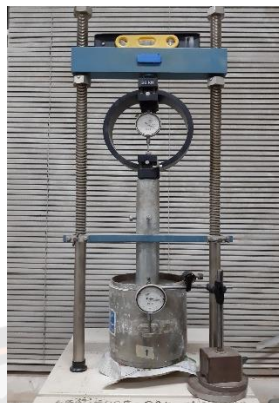
รูปที่ 2-11 การทดสอบ California Bearing Ratio
