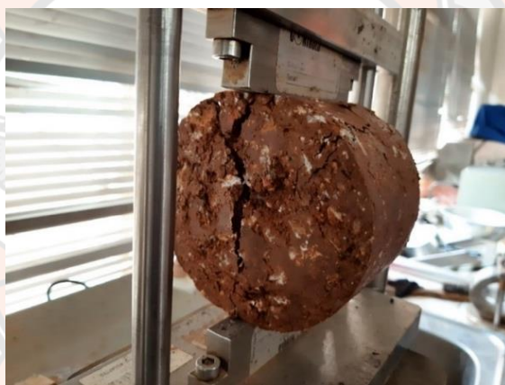
รูปที่ 3-16 การทดสอบ Indirect Tensile Strength
