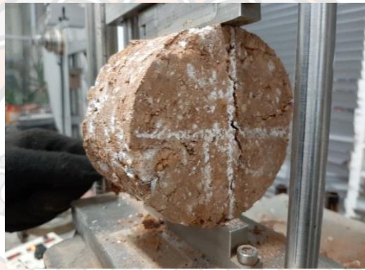
รูปที่ 4-20 ก่อนตัวอย่างกำลังรับแรงดึงทางอ้อม
