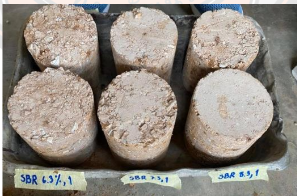
รูปที่ 3-24 ตัวอย่างหลังจากการอบ นาน 42 ชั่วโมง
