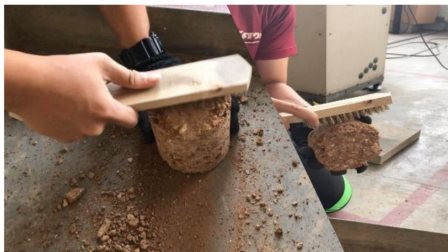
รูปที่ 3-25 การอัดตัวอย่างดินด้วยแปรงทองเหลือง
