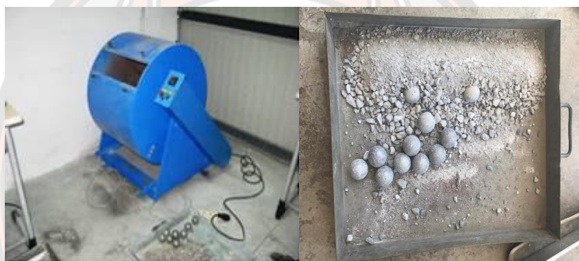
ก. เครื่องทดสอบการสึกหรอ ข. ลูกเหล็กทรงกลม รูปที่ 3-13 การทดสอบหาค่าการสึกหรอ
