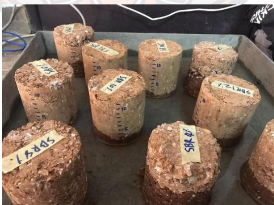
รูปที่ 3-21 ทำการทดสอบแช่น้ำเป็นเวลา 72 ชั่วโมง
