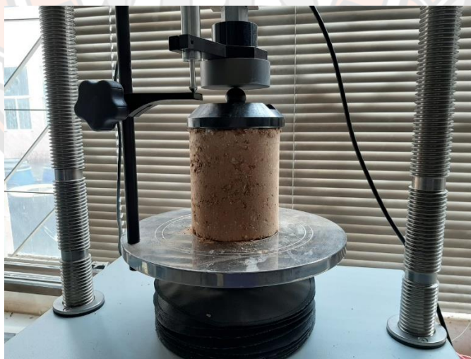
รูปที่ 2-12 การทดสอบแรงอัดแกนเดียว
