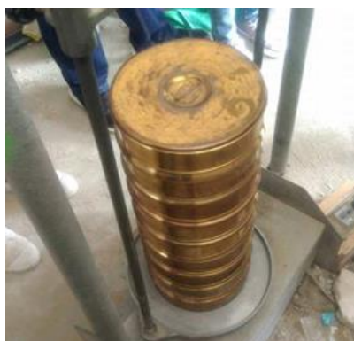
รูปที่ 3-10 การหาขนาดคละของมวลรวมโดยการร่อนผ่านตะแกรง
