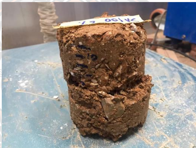
รูปที่ 4-7 ก้อนตัวอย่างที่เสียรูปจากความชื้น
