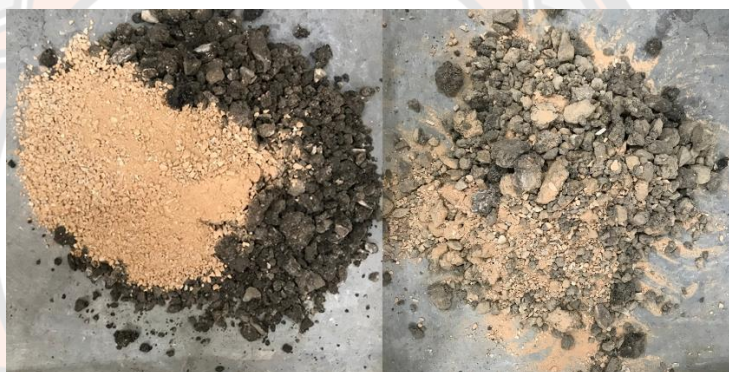
รูปที่ 4-5 วัสดุผิวทางเก่าผสมดินปลายตะแกรงที่อัตราส่วน ( 2 ต่อ 1)
