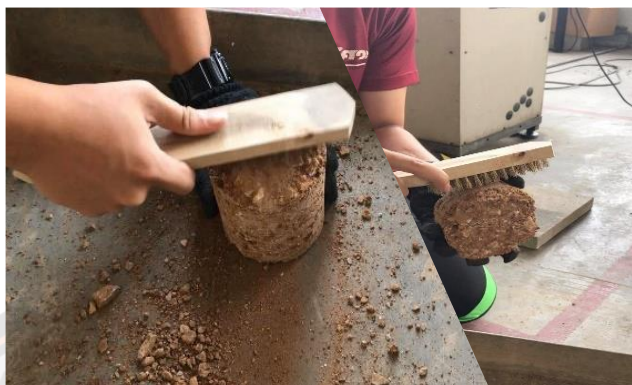
รูปที่ 2-18 การทดสอบความทนทาน (Durability Test)
