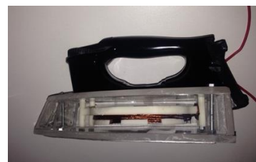
(ฉ) การติดตั้งขดลวด
