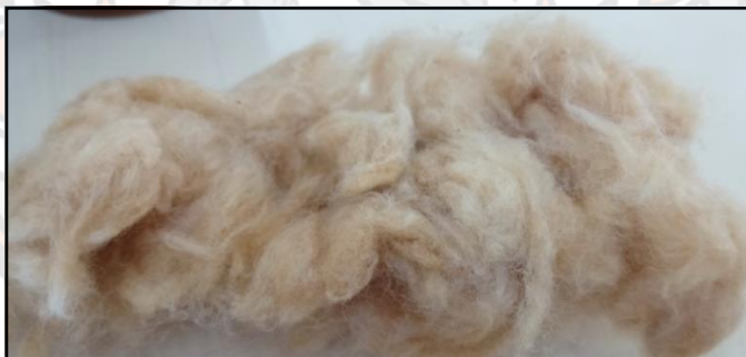
ภาพ 19 เส้นใยโพลีเอสเตอร์ผสมเส้นใยต้นจาก
