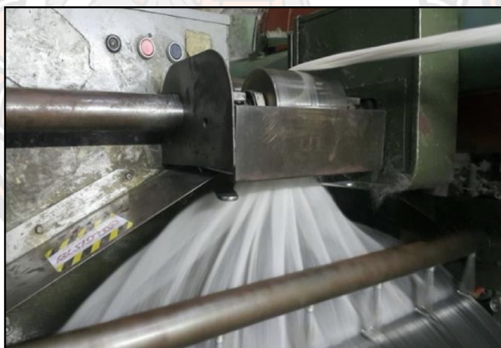
ภาพ 24 นวดเส้นใยด้วยเครื่อง
