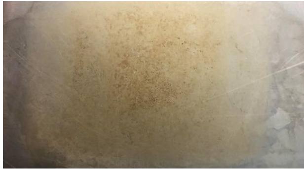
ภาพ 35 การกร่อนของอิเล็กทรอนิกส์หลังการให้ความร้อนแบบไอหม้มิกกับชั้นเนื้อหมู
