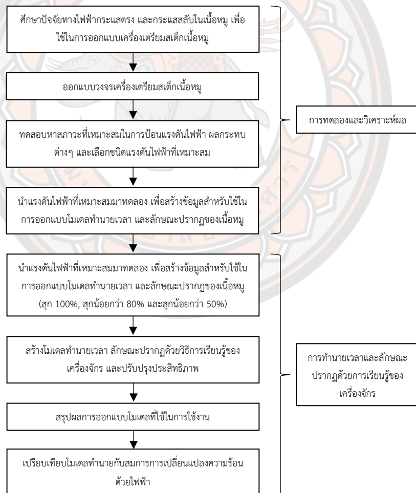
ภาพ 20 แผนผังการดำเนินงานวิจัยในการวิเคราะห์และออกแบบเครื่องเตรียมสติกเนื้อหมู
