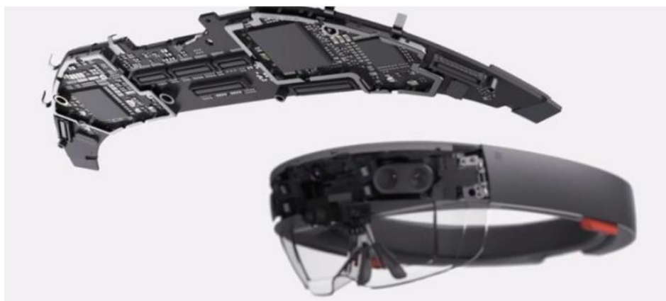
ภาพ 8 รูปแสดงตัวประมวลผลบนบอร์ดโฮโลเลนส์
