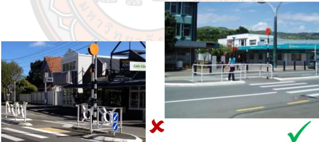
ภาพ 34 ราวป้องกันคนเดินเท้า อาจเป็นอันตรายสำหรับผู้ขับขี่รถจักรยานยนต์หากออกแบบไม่เหมาะสม
