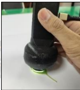
ภาพที่ 14 แสดงการสแกนข้อมูลสเปกตรัมของสารพิษบนตัวกลางชนิดใบกะเพรา
