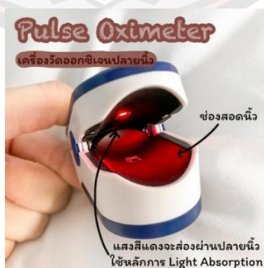
ภาพ 2 เครื่องวัดค่าออกซิเจนในเลือดโดยใช้หลักการ Light Absorption
