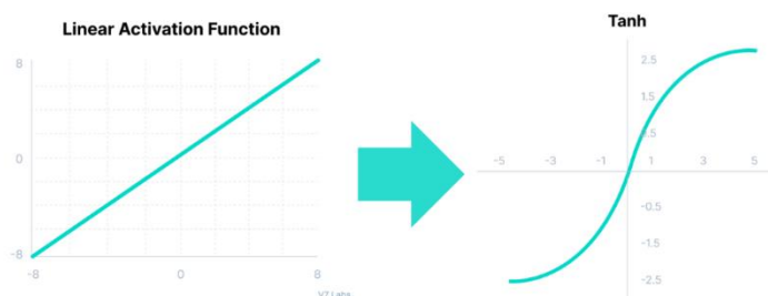
ภาพ 28 การแปลงสมการเชิงเส้นด้วยฟังก์ชัน tanh
