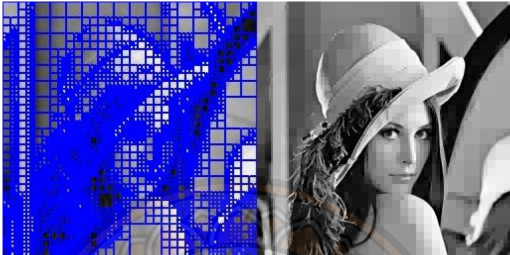
ภาพ 9 การแบ่งส่วนภาพแบบควอดทรี (Quadtree Segmentation) (Definiens, 2007)
