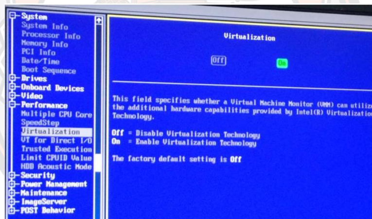
ภาพ 30 แสดงหน้าจอไบออสสำหรับเปิดใช้งานฟังก์ชัน Virtualization
