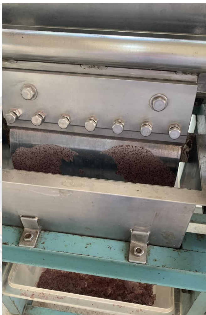
ภาพ 12 กระบวนการทำแห้งไอ้กิ้งสำเร็จรูปเสริมโปรตีนไข่ขาวโดยใช้เครื่องทำแห้งแบบลูกกลิ้ง
