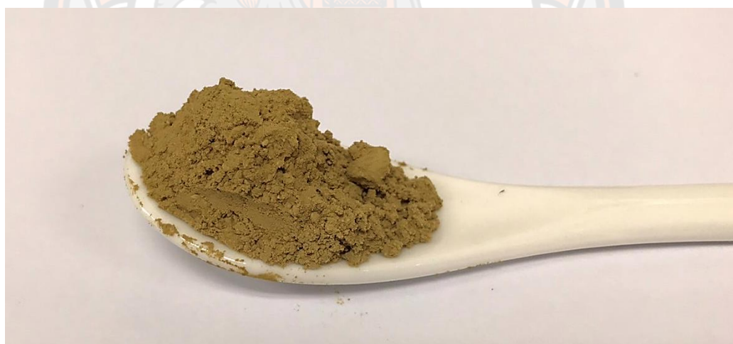
ภาพ 25 ลักษณะสารสกัดจากไข่น้ำจากกระบวนการ US:P:F ผสมสารละลายมัลโตเดรีกติน ร้อยละ 1 ทำแห้งด้วยวิธีพ่นฝอย
