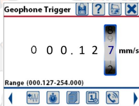
ภาพ 11 Trigger Level Geophone ตั้งเป็น 0.127 มม./วินาที
