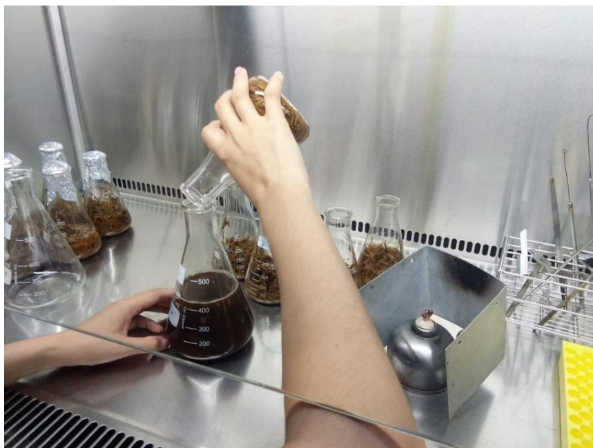
ภาพ 18 แสดงการเก็บตัวอย่างของเหลวจากการย่อยสลายฟางข้าวเพื่อนำไปวิเคราะห์
