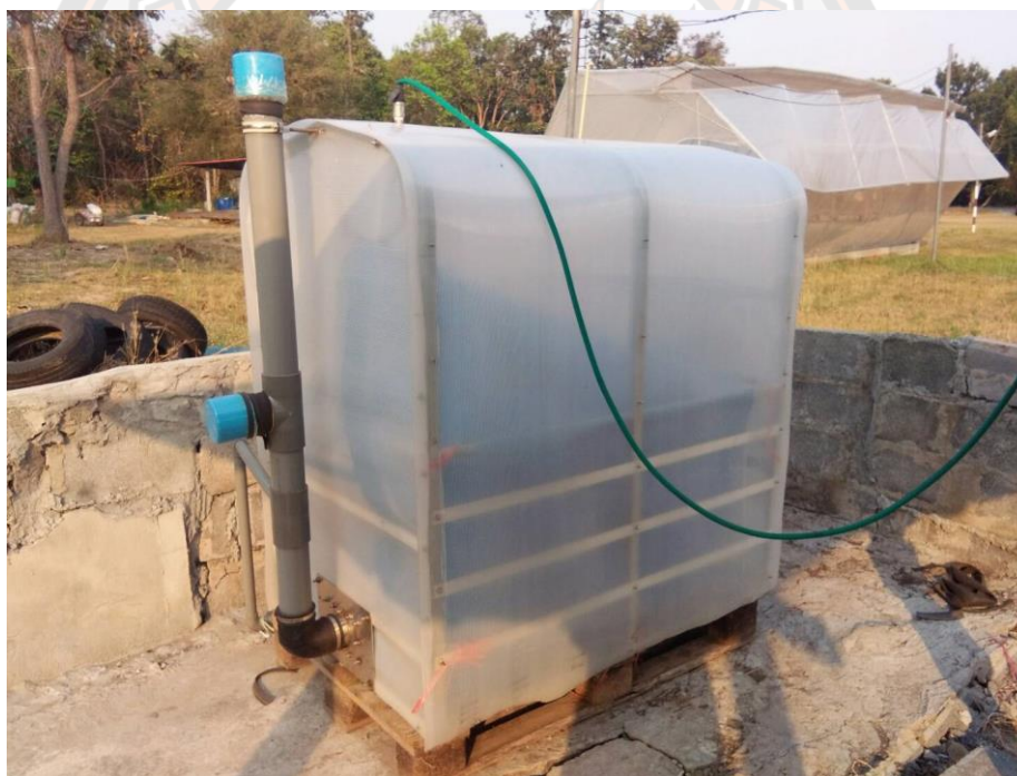
ภาพ 8 แสดงบ่อหมักก๊าซชีวภาพขนาด 1.2 ลูกบาศก์เมตร
