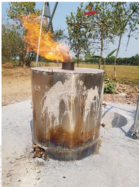
ภาพ 18 แสดงเปลวไฟที่ติดขึ้นหลังจากอุณหภูมิของการเผาถ่านก่อนเปิดเตา
