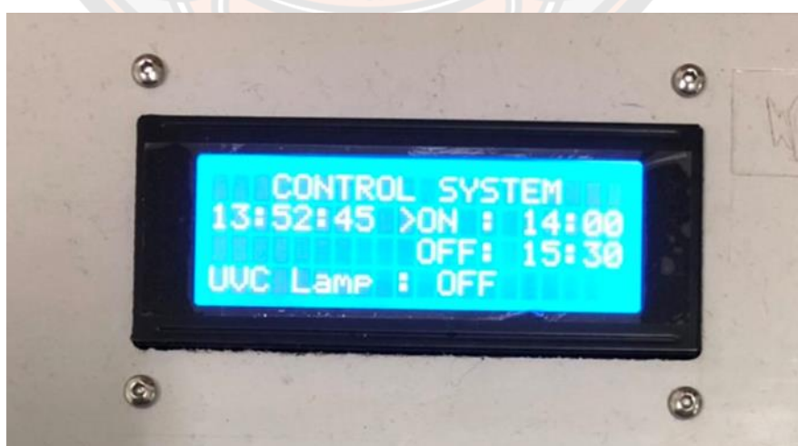
ภาพ 40 เคอร์เซอร์ (>) อยู่ที่ตำแหน่ง ON บนหน้าจอแสดงผล
