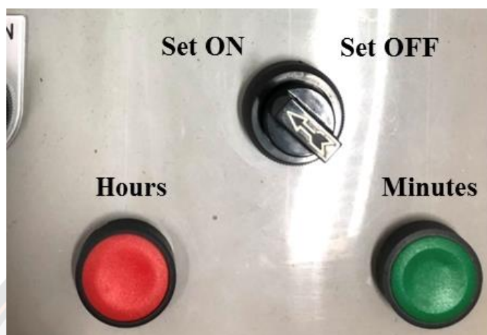
ภาพ 37 ปุ่มกดสำหรับเลือกเวลาการทำงานของแหล่งกำเนิดรังสี UVC
