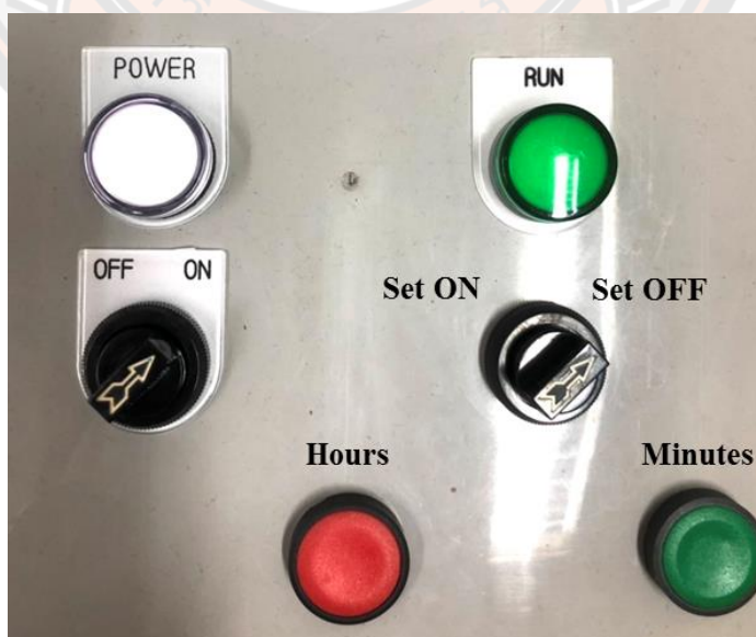
ภาพ 38 การหมุนสวิตช์ตั้งเวลาปิดแหล่งกำเนิดรังสี UVC
