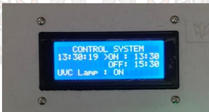
ภาพ 42 สถานะ UVC Lamp : ON บนหน้าจอแสดงผล
