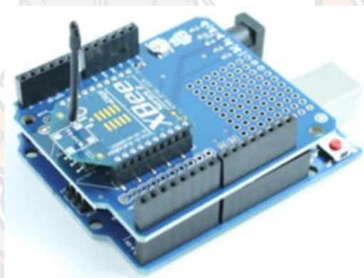
ภาพ 6 บอร์ด Arduino ต่อกับ XBee Shield
