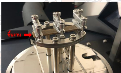
ภาพ 48 การทดสอบสมบัติทางความร้อนของวัสดุเชิงกลแบบไดนามิก โหมด Dual cantilever
