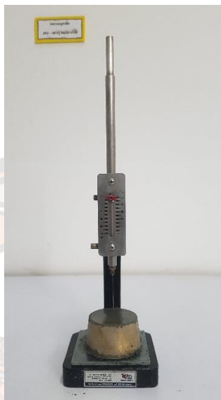
ภาพ 55 การทดสอบการก่อตัวของคอนกรีต โดยวิธีการทดสอบด้วยเทคนิค Vicat needle
