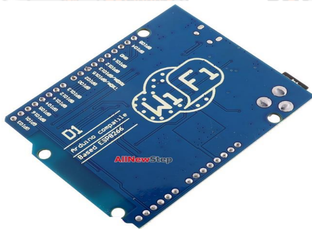
ภาพ 6 แผงวงจรด้านหลังบอร์ดไมโครคอนโทรลเลอร์ WeMos D1 ESP8266 WiFi [7]
