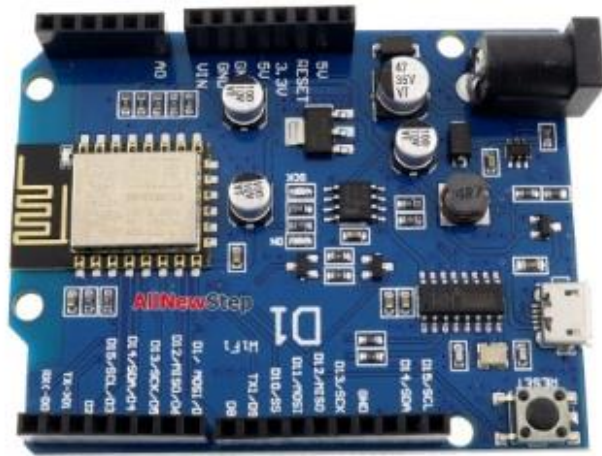
ภาพ 5 แผงวงจรด้านหน้าบอร์ดไมโครคอนโทรลเลอร์ WeMos D1 ESP8266 WiFi [7]
