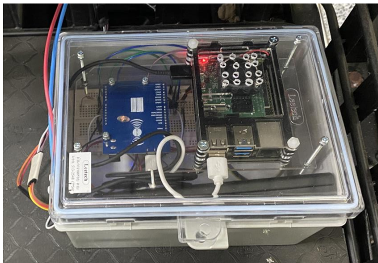
ภาพ 63 วงจรควบคุมระบบแสดงสถานการณ์ใช้งานแบตเตอรี่ของรถไฟฟ้า
