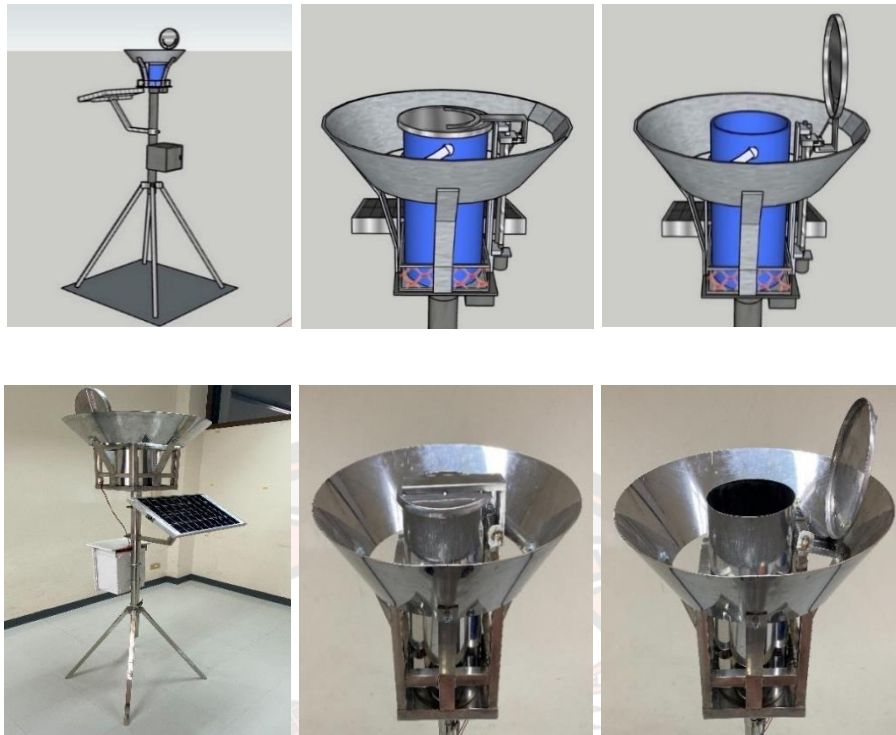
ภาพ 1 แบบร่างและภาพจริงของอุปกรณ์เก็บตัวอย่างฝุ่นตก (Dust-fall Jar) แบบอัจฉริยะ
