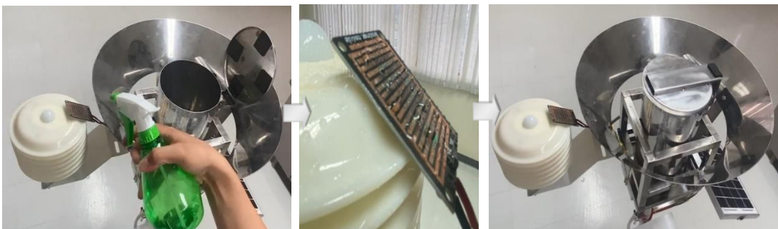
ภาพ 4 การทดสอบการสั่งปิดฝาครอบป้องกันน้ำฝน
