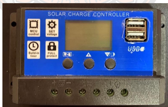
ภาพ 13 โซล่าชาร์จ คอนโทรลเลอร์ (Solar Charge Controller)
