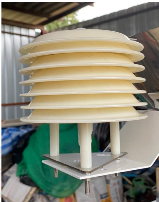
ภาพ 20 เซนเซอร์ตรวจวัดความเข้มแสง อุณหภูมิ ความชื้น (Light, Temperature, Humidity, outdoor transmitter RS485 output)
