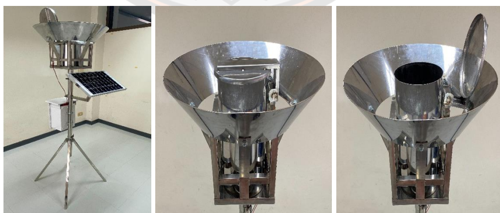
ภาพ 22 ภาพจริงของอุปกรณ์เก็บตัวอย่างฝุ่นตก (Dust-fall Jar) แบบอัจฉริยะ
