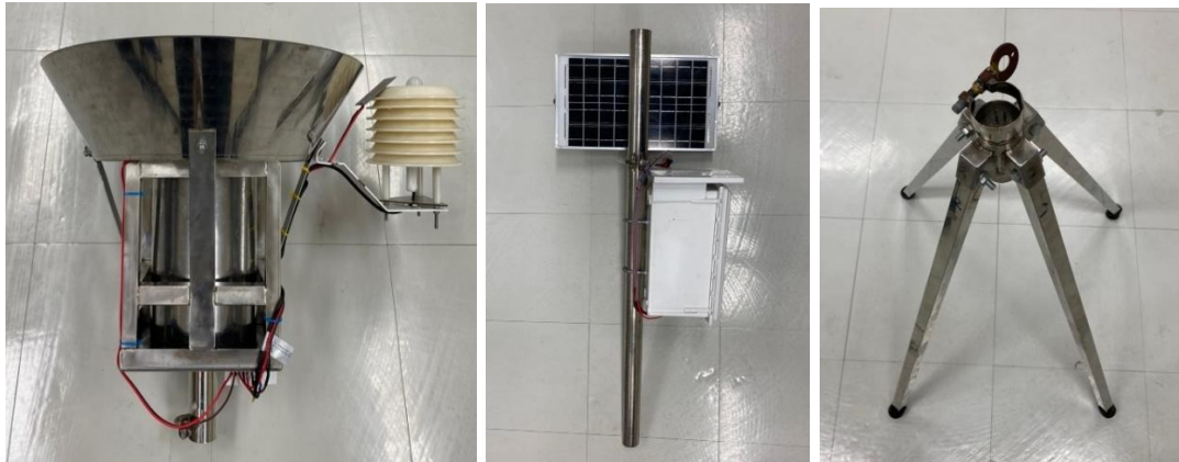
ภาพ 23 โครงสร้างของอุปกรณ์สามารถถอดประกอบเป็น 3 ส่วน
