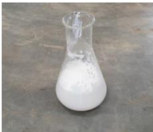
รูปที่ 3-4 พอลิเมอร์ชนิด Styrene-Butadiene Rubber (SBR)
