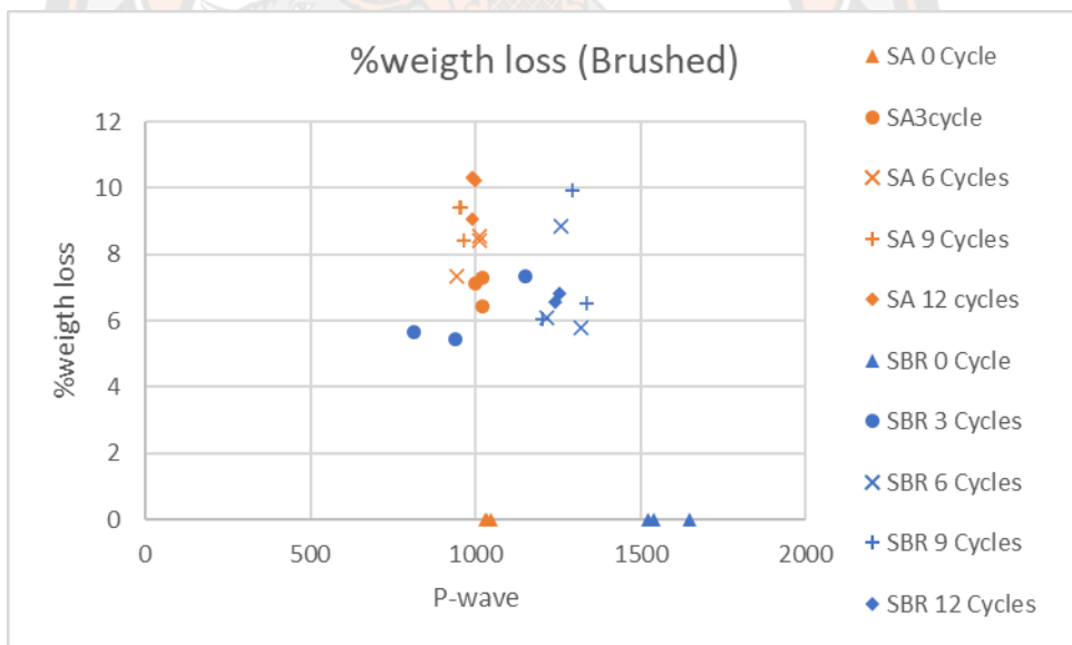
รูปที่ 4-60 กราฟความสัมพันธ์ระหว่างค่าการสูญเสียน้ำหนักสะสมและค่าความเร็วคลื่น P-wave ของวัสดุที่ผ่านกระบวนการเปียกสลับแห้งผ่านการขัดของวัสดุทั้ง 2 ชนิด
